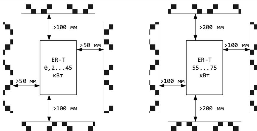
Рисунок 6 – Воздушные зазоры для установки ПЧ, не менее
