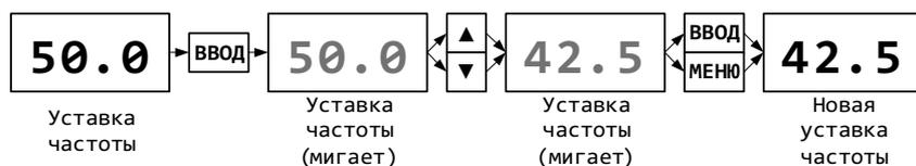
Рисунок 23 –Изменение частоты с панели оператора
