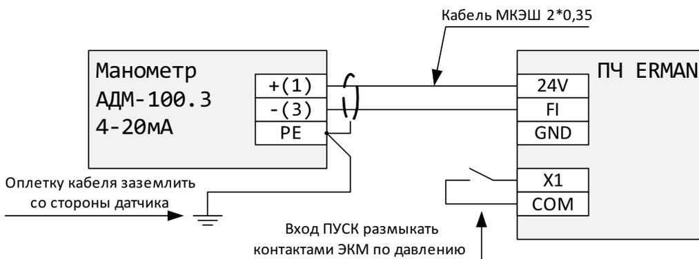
Рисунок 15 – Подключение электронного манометра АДМ-100.3
