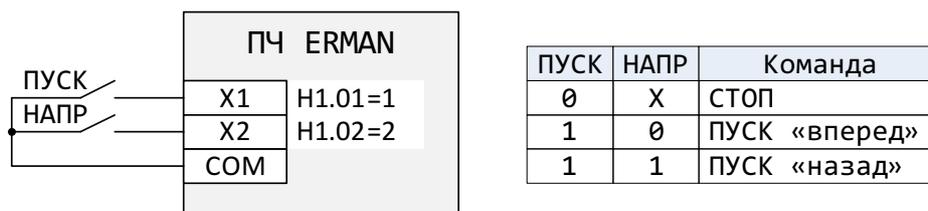
Рисунок 26 – Двухпроводная схема управления
