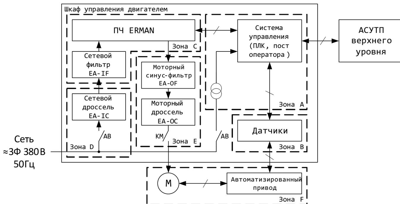
Рисунок 20 – Способ размещения устройств автоматизации в шкафу
