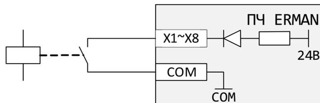
Рисунок 11 – Подключение сигнала типа «сухой контакт»
