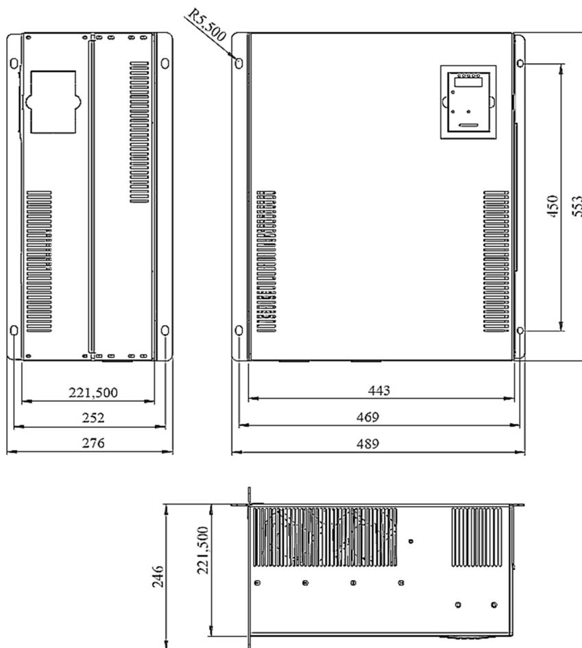
Рисунок 5 – размеры ПЧ мощностью от 37 до 75 кВт
