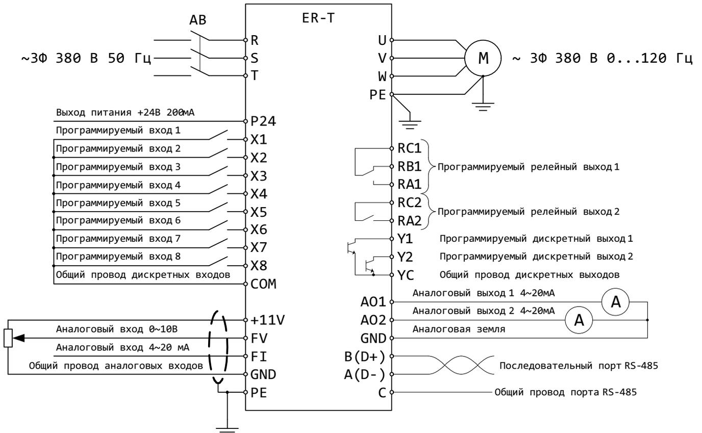
Рисунок 10 – Подключение сигналов управления к ПЧ
