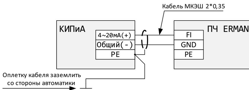
Рисунок 14 – Подключение сигнала типа «4-20 мА»
