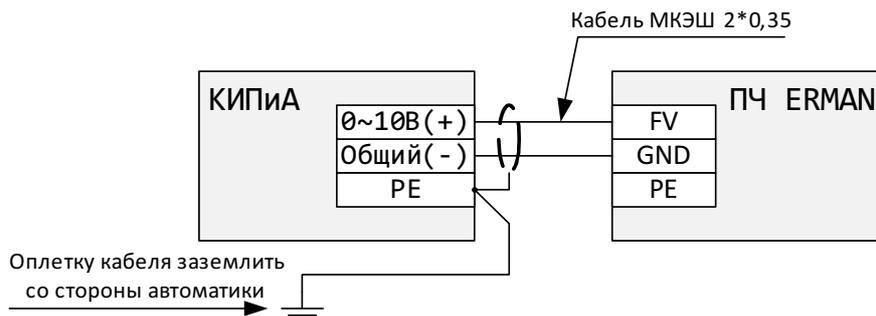
Рисунок 13 – Подключение сигнала типа «0-10 В»
