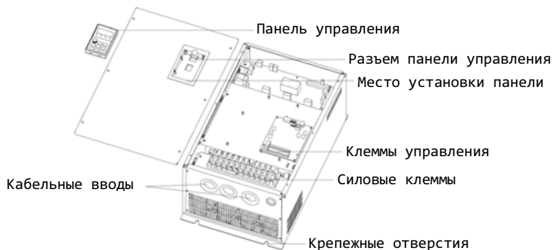
Рисунок 5 – Модели мощностью от 18 кВт до 45 кВт
