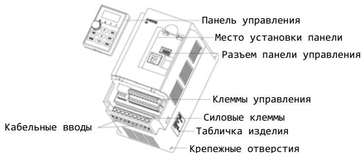
Рисунок 3 – Модели мощностью до 3,7 кВт
