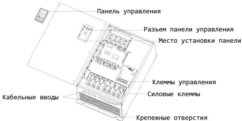
Рисунок 6 – Модели мощностью от 55 кВт и выше
